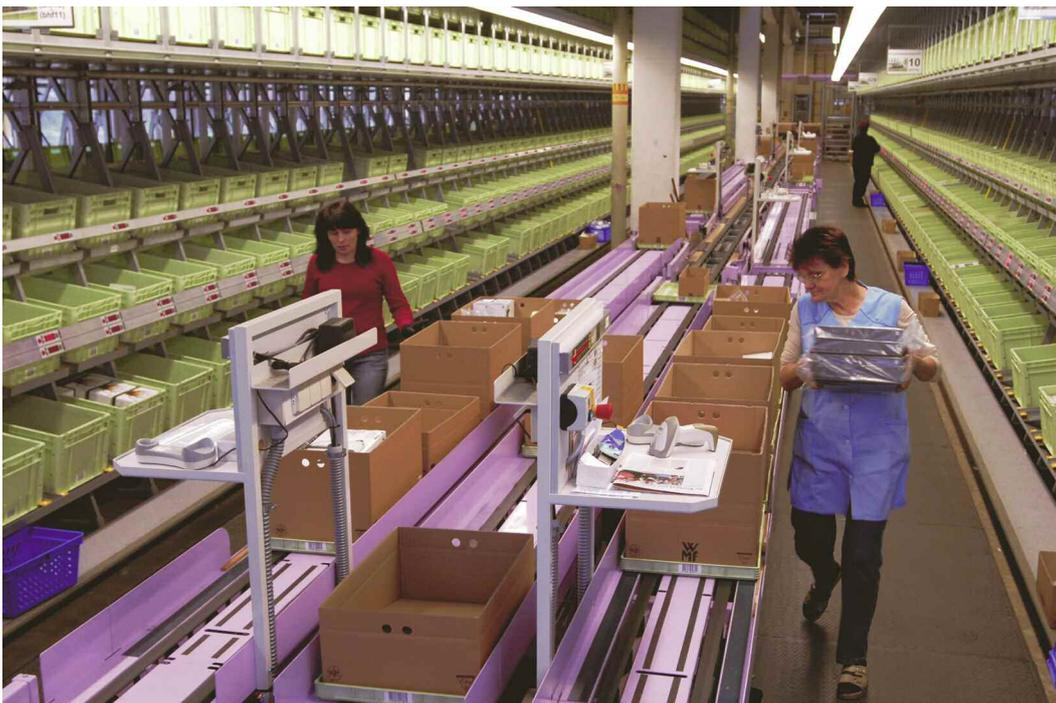
**Das ‚High Performance Picking System‘ (HPPS) von Viastore Systems sorgt durch eine ausgeklügelte Kombination von Software und Mechanik für hohe Kommissionierleistungen**
