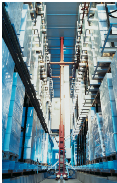
Regalfahrzeug im Satellitenlager von Agristo bei Temperaturen von -28 °C
