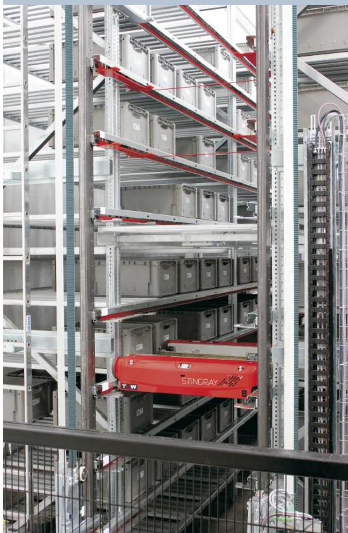
Mit dem Shuttle-System Stingray hat TGW das Spektrum bei AKL-Lösungen im Hochleistungssegment vervollständigt
