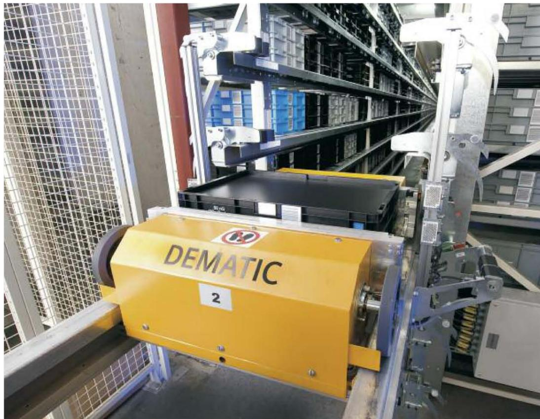
Bei Bosch Rexroth in Laatzen wird eine Multishuttle-Anlage als Puffer zwischen dem vorhandenen AKL und der Kommissionierzone eingesetzt
