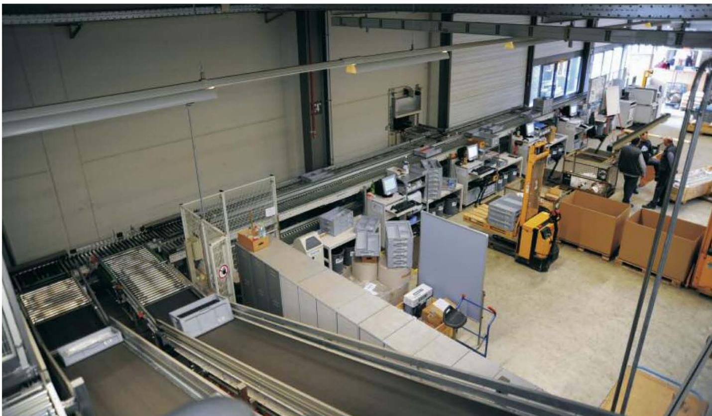
**Förderanlage zum Wareneingangsbereich. Die Behälter kommen aus dem bereits zuvor vorhandenen automatischen Kleinteilelager**
