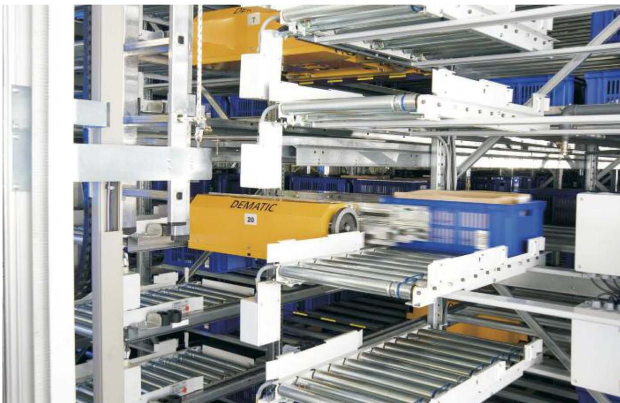
**In der Multishuttle-Anlage bei Bosch Rexroth in Laatzen bei Hannover fährt auf jeder Ebene ein Shuttle-Fahrzeug – insgesamt zehn Shuttles**
