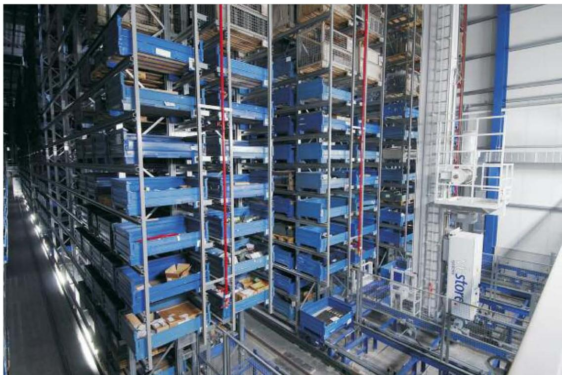
**Automatisches Hochregalpalettenlager von Viastore Systems, implementiert beim Landmaschinenhersteller Claas in Harsewinkel**
