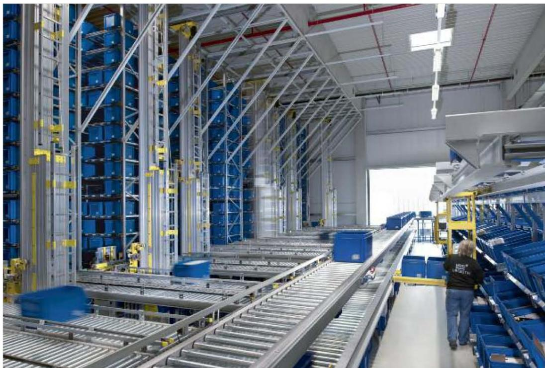
**Ein automatisches Kleinteilelager von PSB dient bei Montblanc als Zentralsystem zwischen Wareneingang, Kommissionierung und Versand**
