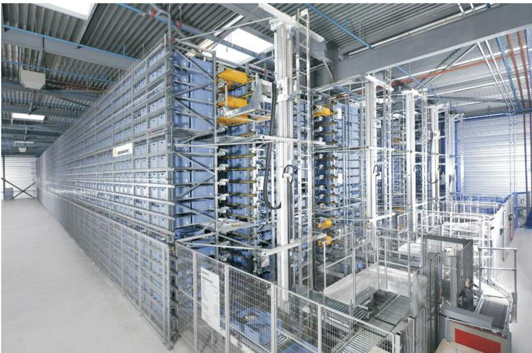
**Das Multishuttle-Lager bei der SFS Unimarket AG ist ein kompaktes, automatisches Kleinteilelager auf Behälterbasis, das direkt unter SAP EWM verwaltet und gesteuert wird**
