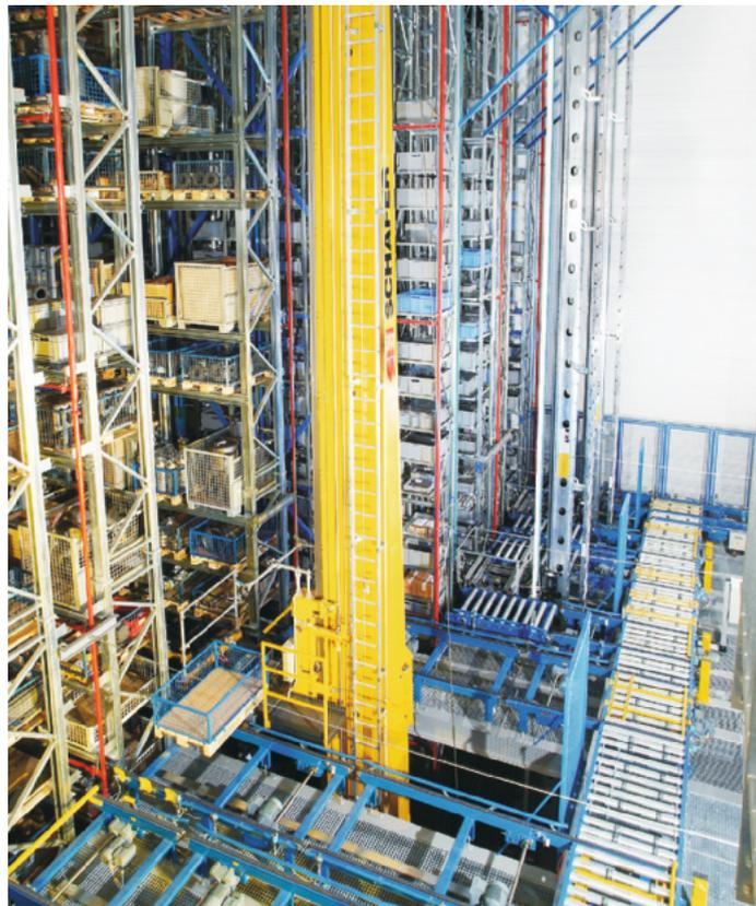
**Vorzone eines kombinierten automatischen Lagers von SSI Schäfer mit Paletten und Behältern als Ladungsträgern**
