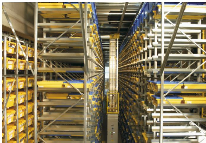
**Hochleistungsregalbediengerät in einem von PSB realisierten automatischen Kleinteilelager im Einsatzbereich Pharma**
