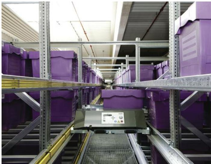
**Die neue Generation OSR-Shuttle von Knapp kann Ladegut unterschiedlicher Größen bis zu vierfach tief lagern**
