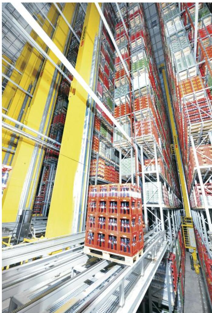
**Vollautomatisches Hochregalpalettenlager von SSI mit einer Höhe von 44 m. Die Regalbediengeräte speisen Energie zurück**
