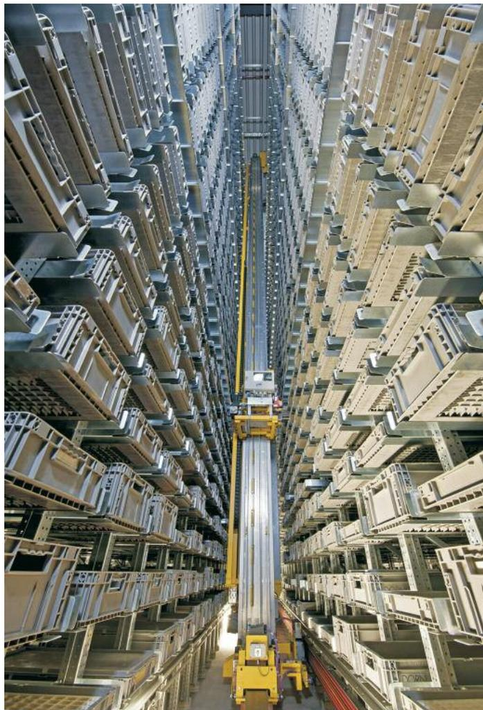
**Automatisches Kleinteilebehälterlager von PSB. Neben konventionellen AKLs bietet PSB auch Shuttle-Lösungen an**
