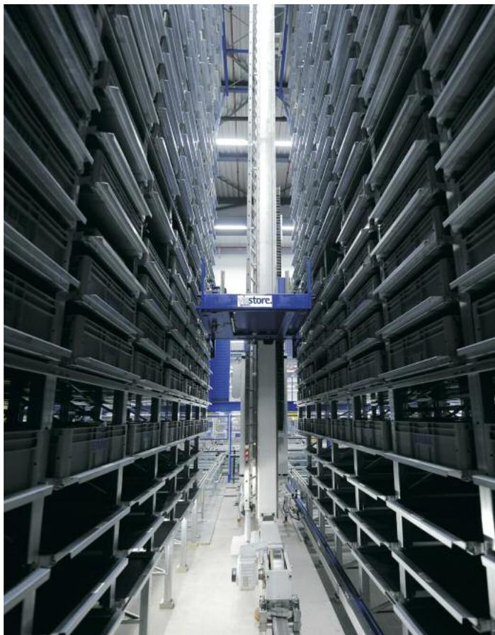
**Vollautomatisches Kleinteilelager mit Kunststoffbehältern als Ladungsträger. Das Viastore-AKL wurde bei Erbe implementiert**
