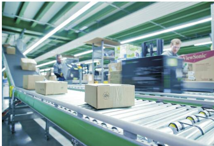
Die Kommissionierung und die neue 1,5 km lange Förder-technik sind bei Bechtle in Neckarsulm nun systemgesteuert
