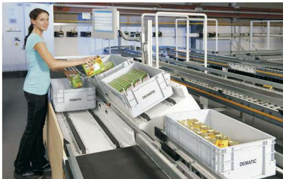
**Kommissionierstation Rapidpick von Dematic. Die IT steuert die Ver- und Entsorgung der Behälter über die Fördertechnik**
