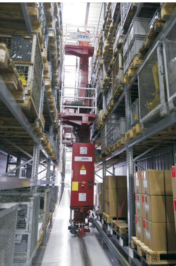
Das Palettenlager mit dem RBG Viapal bietet Platz für 897 Paletten und Gitterboxen
