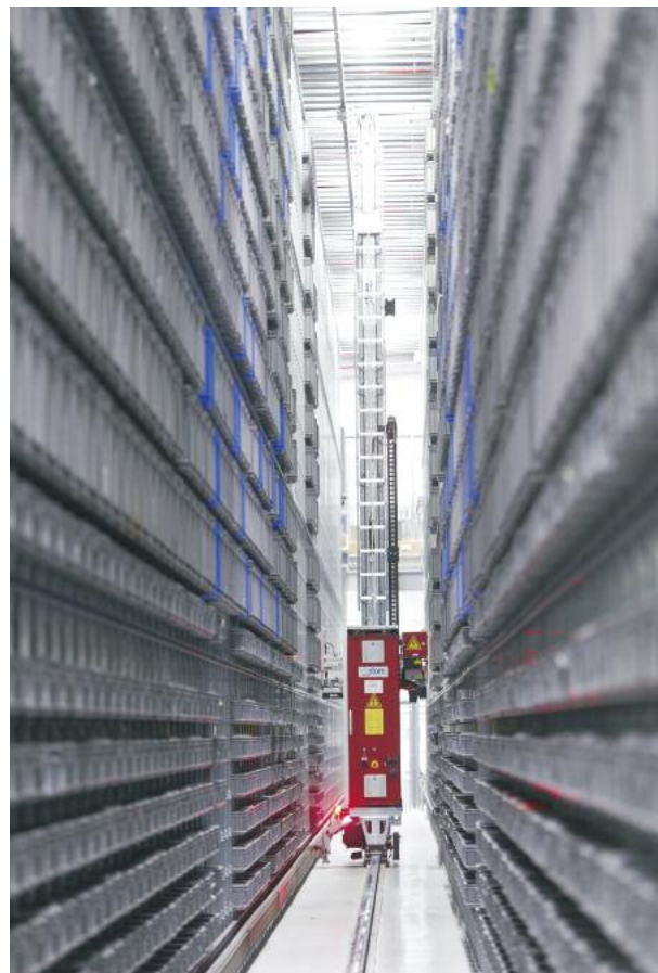
Das schnelle AKL-Regalbediengerät Viaspeed hat eine Spitzengeschwindigkeit von 6 m/s
