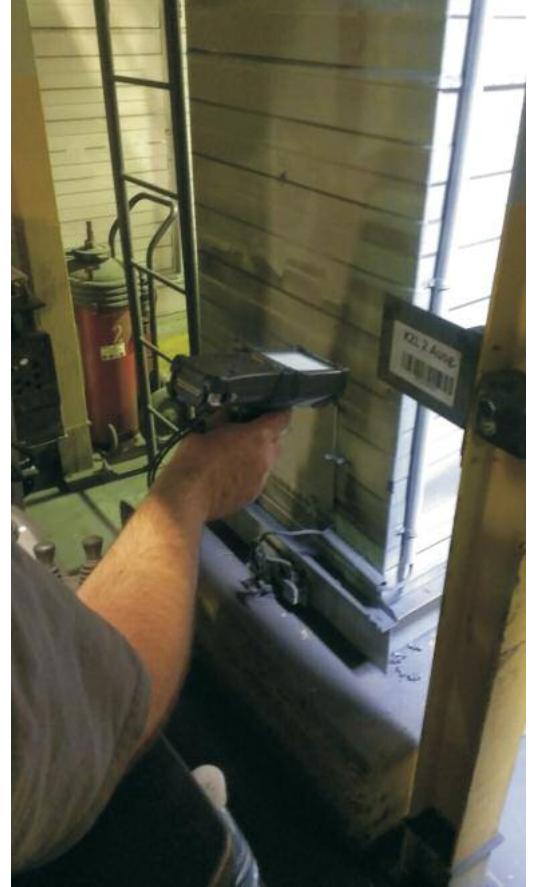
Die Übergabe der Sandkerne auf die Fördertechnik wird per Scan an das WMS gemeldet
