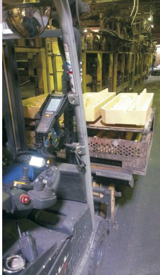
Über WLAN werden die Fahraufträge vom WMS auf die Staplerterminals übermittelt
