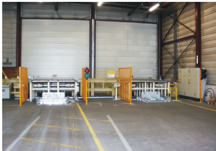
Andock- und Justiereinrichtung für die Ausrichtung des Verladesystems für den Transport der Papierrollen in den Lkw
