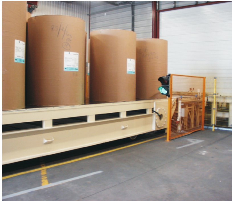
Papierrollen auf dem Verladesystem. Die Fördertechnik für Traglasten für bis zu 50 000 kg ist mit einem Gurtbandförderer ausgestattet
