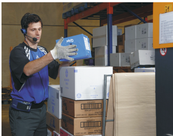
Kommissionierer mit Pick-by-Voice-Talkman und Headset. Der Lagerrechner kommuniziert direkt mit dem Mitarbeiter
