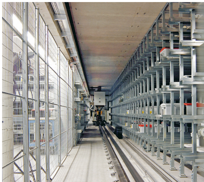
Regalfahrzeug im Automatischem Kleinteilelager ‚Miniload‘ beim Soltartechnik-Zulieferer SMA Technologie AG
