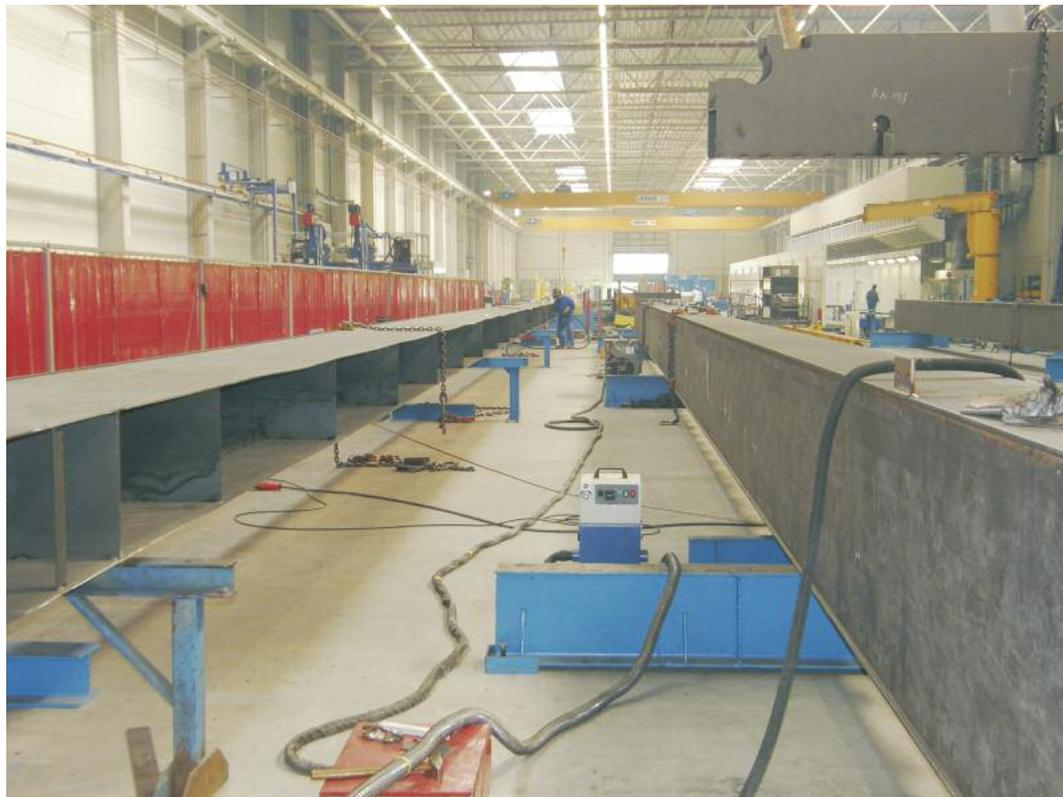
**Der Anlagenbauer MLog verfügt am neuen Standort Neuenstadt über 200 m lange Produktionshallen. Bis zu 45 m lange Regalbediengeräte lassen sich in einem Stück herstellen**
