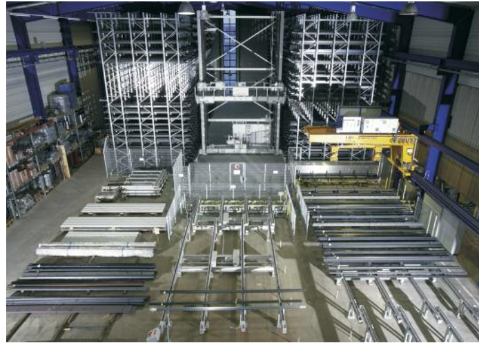
Wabenlager Unicomact von Kasto mit stirnseitigen Auslagerstationen zum Kommissionieren im Stahlhandel
