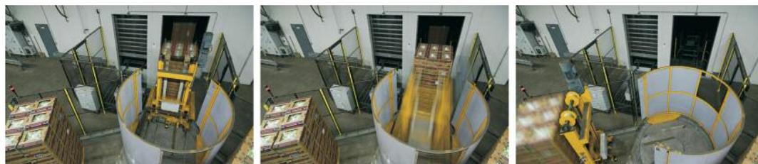
**Die Sonderkonstruktion Ballerina: Die Hydraulikscherenkonstruktion von Egemin stellt die palettierten Bananen am Warenausgang zur Verladung und weiteren Distribution bereit**
