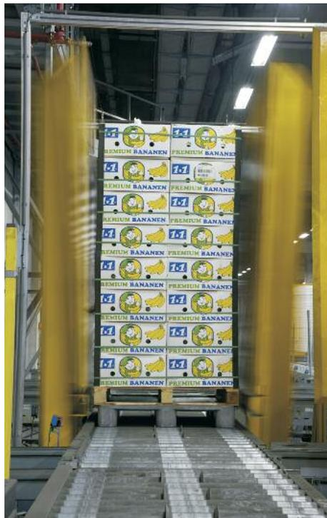
Vor der Einlagerung ins Lager werden die Konturen der Paletten überprüft
