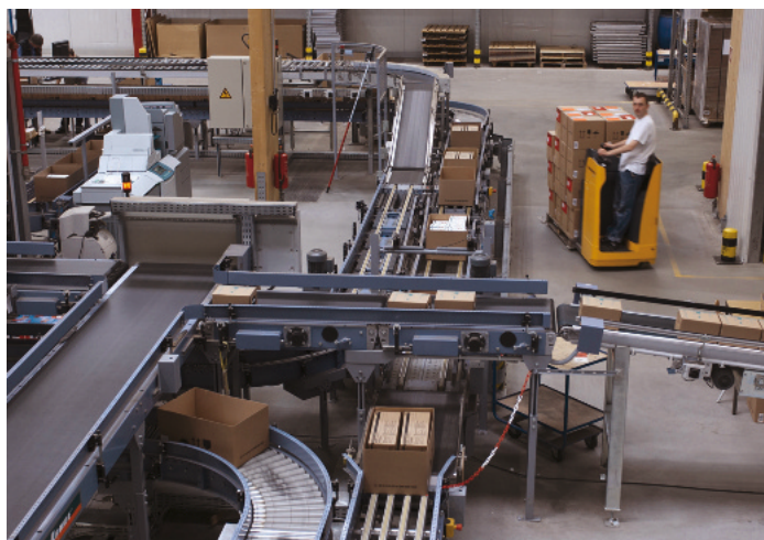
Mehrgurttechnik wird von Vanderlande vermehrt eingesetzt. Damit lässt sich die Geräuschentwicklung deutlich reduzieren
