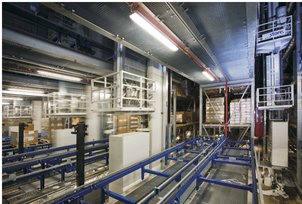
Blick aus einem Lagerregal in das neue neungassige Hochregalpalettenlager im Logistikzentrum Süd der Paul Hartmann AG. Zu sehen sind vier der neun Regalbediengeräte
