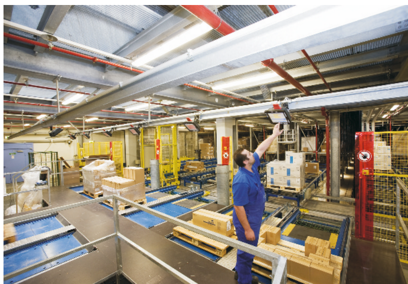
In der Vorzone des neuen automatischen Palettenhochregallagers der Hartmann-Gruppe unterstützen übersichtliche Dialoge auf Touchscreens die Kommissionierer bei ihrer Arbeit
