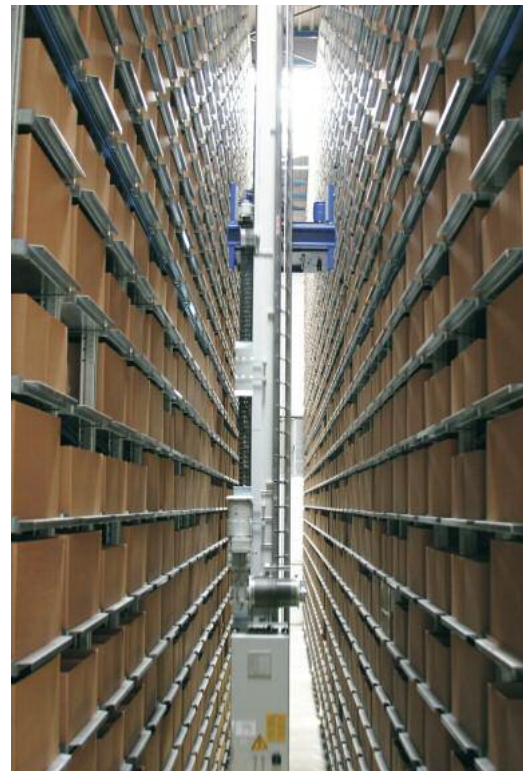
Bei der M&S Armaturen GmbH in Friedeburg finden in den zwei Gassen des Tablarlagers 5 200 Tablare Platz
