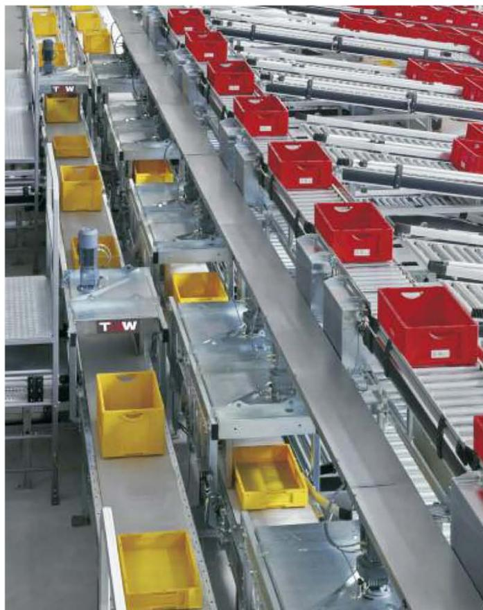
**TGW-Behälterfördertechnik bei Aesculap**
