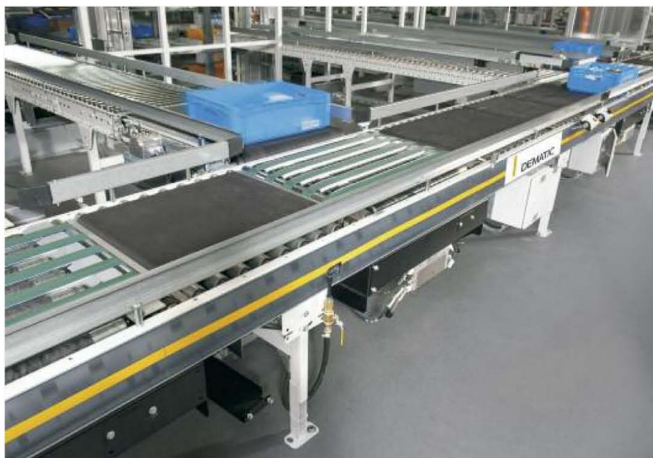
**Förder- und Sortiertechnik für Behälter von Dematic**
