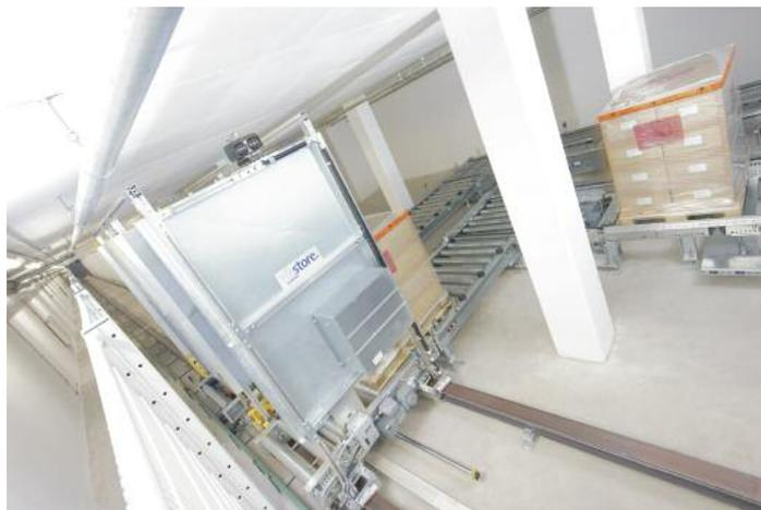
**Auch der 120 m lange Fördertechnik-Tunnel, der Hochregallager und Versand verbindet, wurde von Viastore realisiert**
