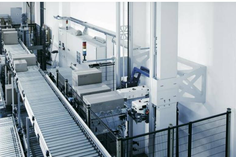
Die Viflex-Shuttles nehmen die Kartons durch Unterfahren auf. Daher dürfen deren Abmessungen variabel sein
