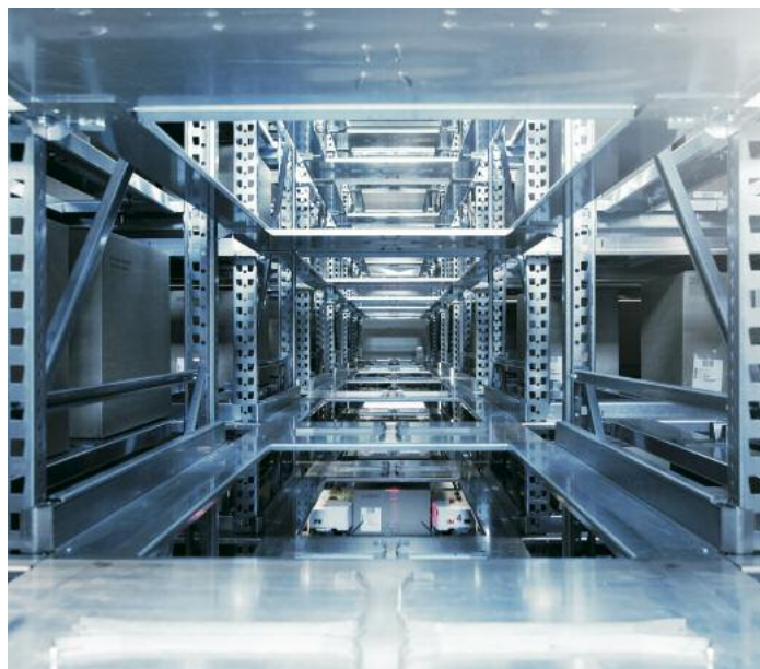
Die Vialflex-Shuttlesysteme können selbstständig die Regalgänge wechseln. Das ermöglicht eine hohe Lagerdichte
