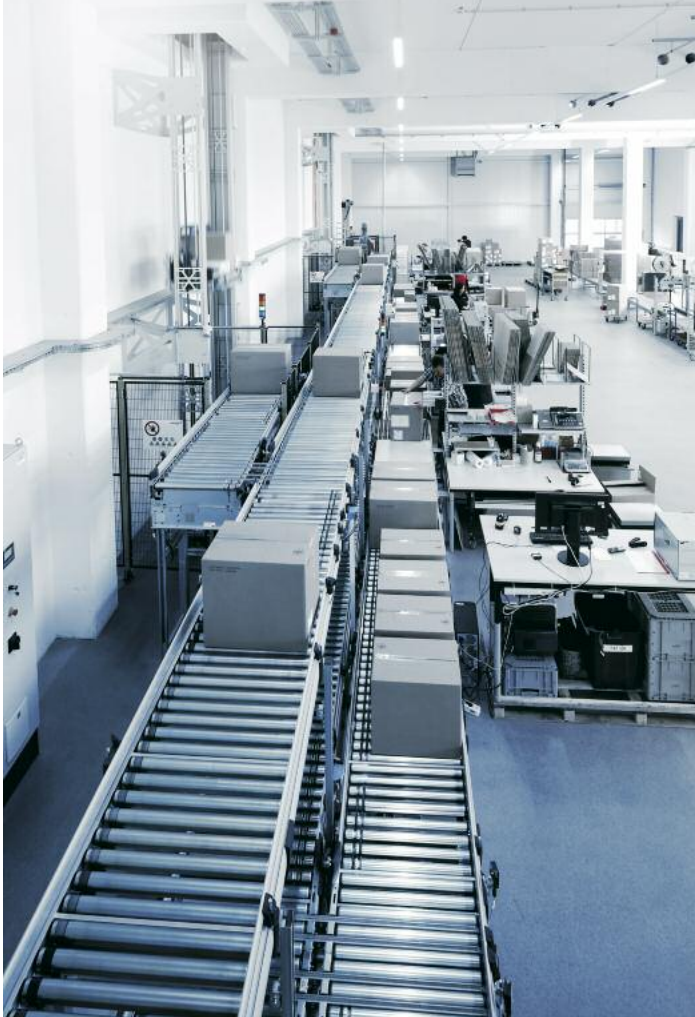
Im Erdgeschoss befinden sich bei Weisser die Einlagerstrecke sowie sechs Kommissionierplätze, die über einen Fördertechnik-Loop miteinander verbunden sind
