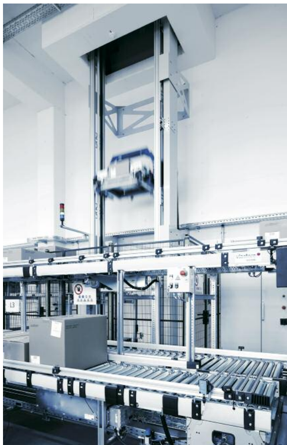
Lifte heben die Shuttles mit ihren Behältern oder Kartons von der Einlagerung ins Lager und auf die entsprechende Regalebene
