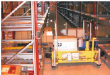
Die durch vier Seile gehaltene Transfaster-Plattform mit dem Lastaufnahmemittel bei der Auslagerung einer Palette
