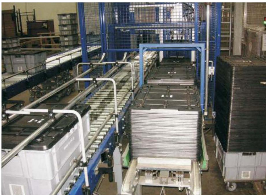
**Vor der versandfertigen Bereitstellung der Mehrwegtransportbehälter werden diese automatisch gedeckelt**
