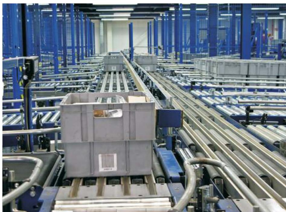
Behälterloop im Verdichtungsbereich mit automatisierter Förder- und Sortiertechnik von Vanderlande Industries
