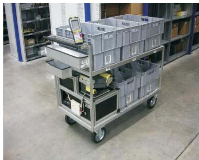
Kommissionierwagen mit Behältern und Datenerfassungsgerät im Fachbodenlager
