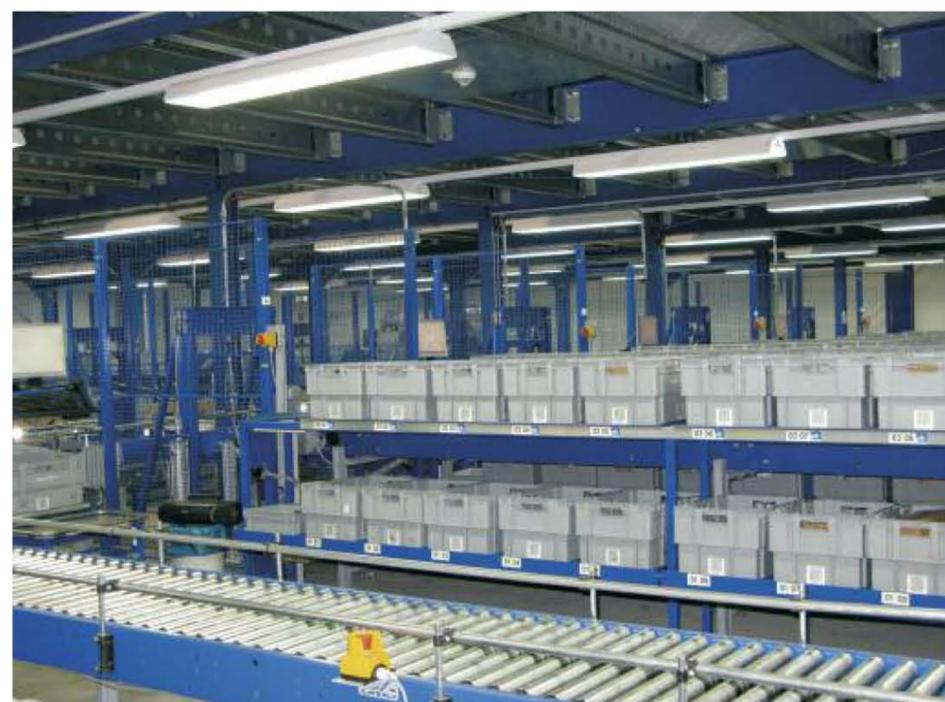
Verdichtungsbereich zur Kommissionierung der Händlerbehälter mit Unterstützung von Pick-to-Light-Anzeigen
