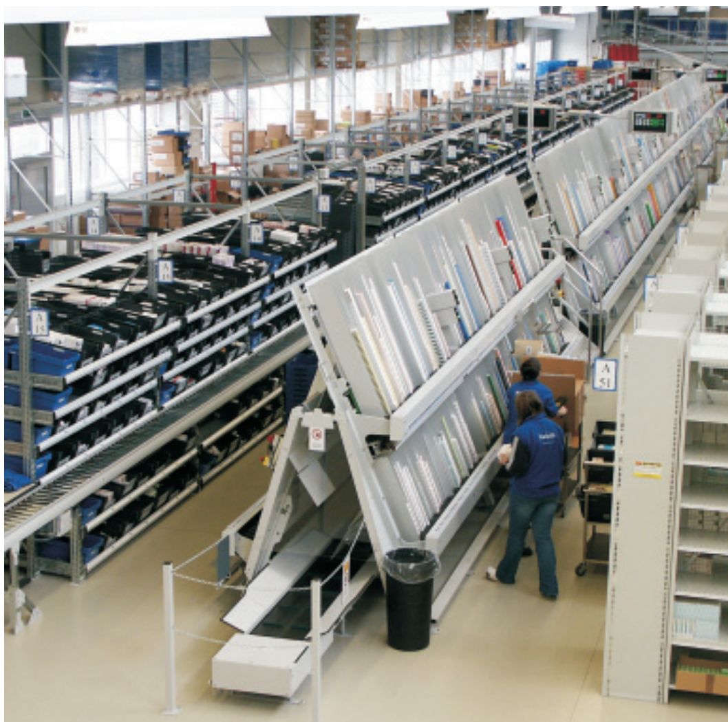
Zentrale Anlagenkomponente beim Pharma-Großhändler Kwizda ist ein CFC-Automat für die hochdynamische Kommissionierung
