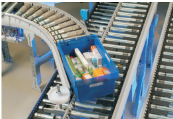
Für den internen Transport und die Auslieferung kommen zwei Behältergrößen (11 und 21 cm Höhe) zum Einsatz
