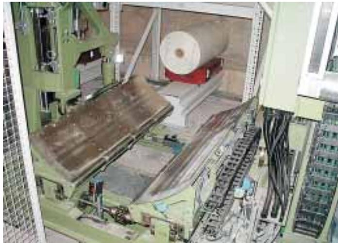
**An der Abwickelstation werden die Papierrollen für den fliegenden Rollenwechsel bei der Rotation verklebt**
