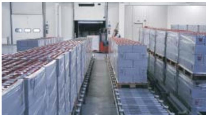
Der Materialflussrechner steuert die Paletten gemäß Kundenauftrag in der Verladereihenfolge an die Versandbahnen
