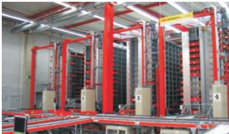
Automatisches Karusselllager beim Dienstleister Würth Industrie Service
