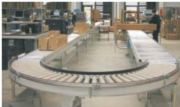
Rollenförderer zur Beförderung von Kartons im Kommissionierbereich. Die Kurven können zu Problemzonen werden
