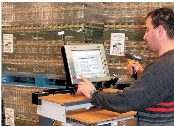
Im Wareneingang werden die Paletten etikettiert. Dafür gibt es mobile Arbeitspulte mit Barcodescanner und Funk-PC
