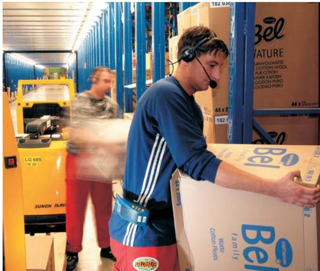
Dem Kommissionierer wird Ort und Anzahl der Artikel mitgeteilt. Er bestätigt während der Entnahme per Mikrofon
