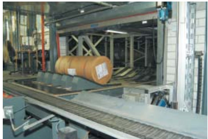
Das schonende Handling der Papierrollen übernehmen spezielle Wippvorrichtungen mit Rollenführung
