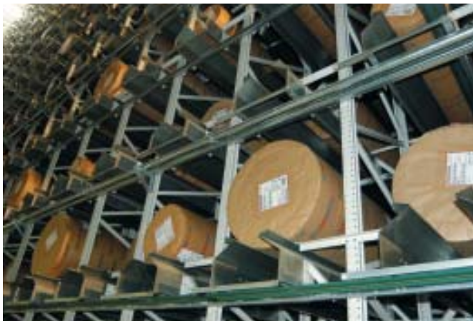
Die bis zu 2 100 kg schweren Papierrollen werden in drei Lagerblöcken in 14 Ebenen und 1 500 Kanälen gelagert
