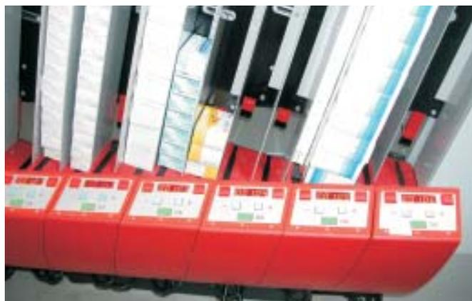
**Die klar strukturierte Bedieneinheit an jedem Schacht des A-Frame ermöglicht schnellen und korrekten Nachschub**
