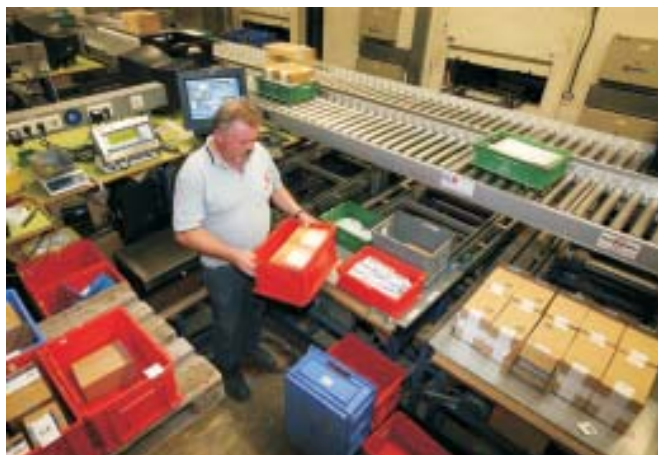
Fördertechnik in der Vorzone zum automatischen Lager, in der auch Kommissionierprozesse stattfinden
