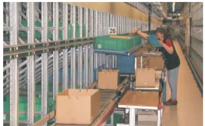
Kommissionierarbeitsplatz innerhalb des automatischen Kleinteilelagers, der durch Regalbediengeräte versorgt wird
