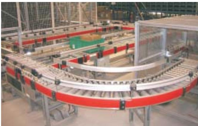
**Förder- und Sortiertechnik für Kommissionierbehälter und Kartons im automatischen Kleinteilelager von Alka**
