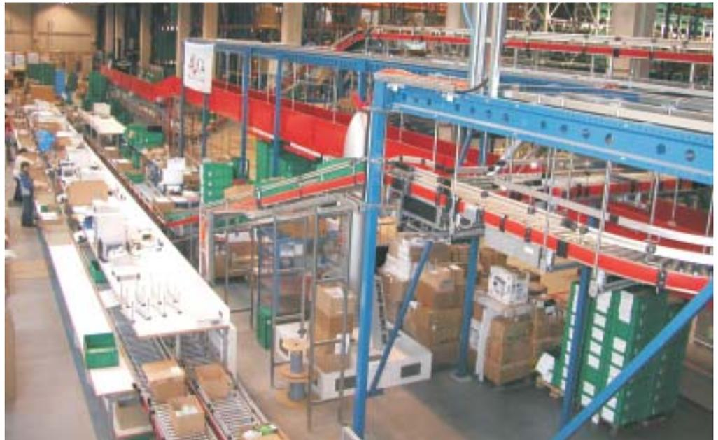
Pack- und Kommissionierarbeitsplätze (links unten), die von der vom AKL kommenden Fördertechnik versorgt werden. Im Hintergrund das Palettenlager, daneben das Behälterlager
