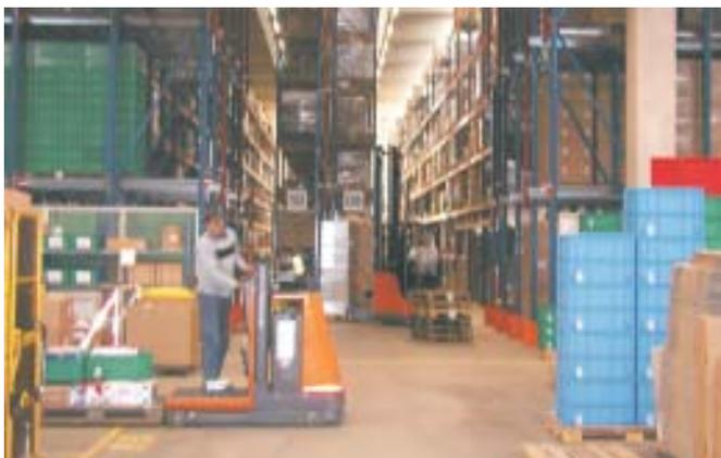
Das konventionelle Paletten-Hochregallager wird durch Manngeführte Hochregalstapler bedient
