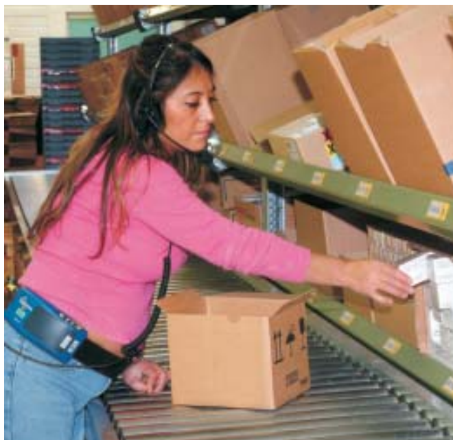
KommissioniererIn bei der sprachgesteuerten Entnahme der Ware am Regal, deren Vollzug sie über Mikrofon bestätigt
