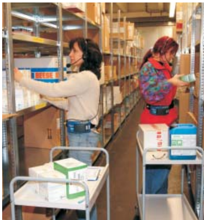
Bei Logosys werden die Talkman-Terminals und die Dialoge direkt aus dem Lagerverwaltungssystem gesteuert
