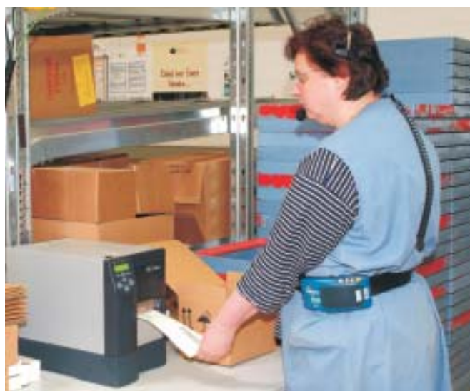
Zu Beginn eines jeden Kommissioniervorgangs wird ein Barcodeetikett für den Versandkarton ausgedruckt
