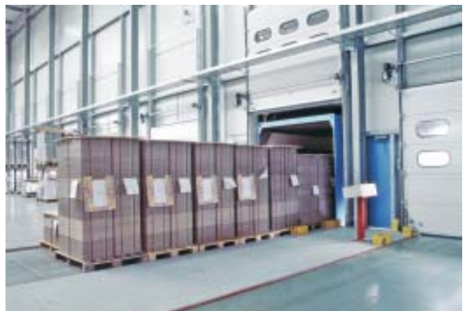
Über das Transportbandsystem wird die Ware automatisch vom Lkw hinein beziehungsweise hinaus gefördert
