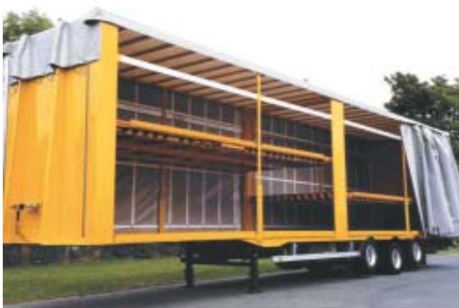
Der Flexiloader verfügt über geteilte Böden, die je nach Ladung als Hubböden variabel verstellbar sind
