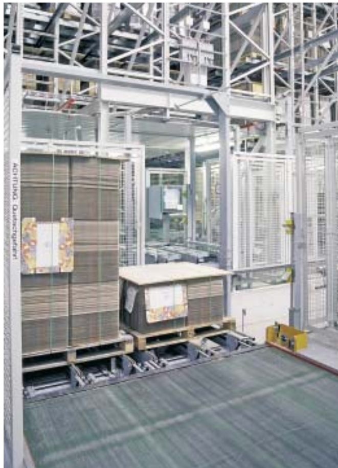
Ein Doppel-Quertransportwagen nimmt die Ware vom Transportbandsystem und leitet sie weiter in das Lager
