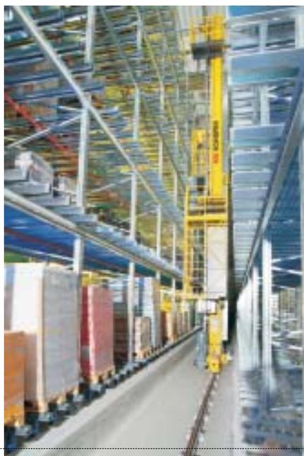
Im halbautomatischen Hochregallager von Netto sind insgesamt acht Regalbediengeräte für die Ein- und Auslagerprozesse zuständig. Sie versorgen 9 700 Palettenstellplätze. Es sind 209 Ein- und 234 Auslagerungen pro Stunde möglich. Die Einlagerung erfolgt doppelt tief, bei Düsseldorfer (Halb-)Paletten entsprechend vierfach tief
