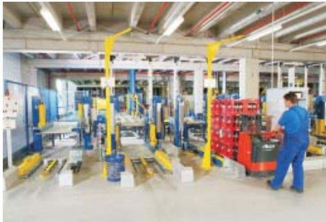
Im Wareneingangsbereich werden die Paletten mit Hilfe elektrischer Gabelhubwagen auf die Förderanlage aufgesetzt
