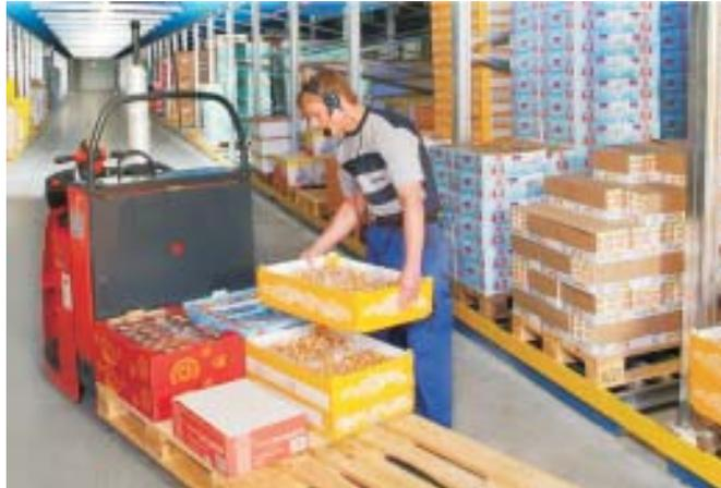
Beim ‚Pick-by-Voice‘ erhält der Kommissionierer direkt aus dem Lagersystem ‚Ant‘ Sprachanweisungen auf das Headset
