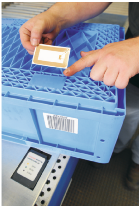
Behälter mit Folientransponder und RFID-Schreib-Lese-Station bei Lapp Kabel
