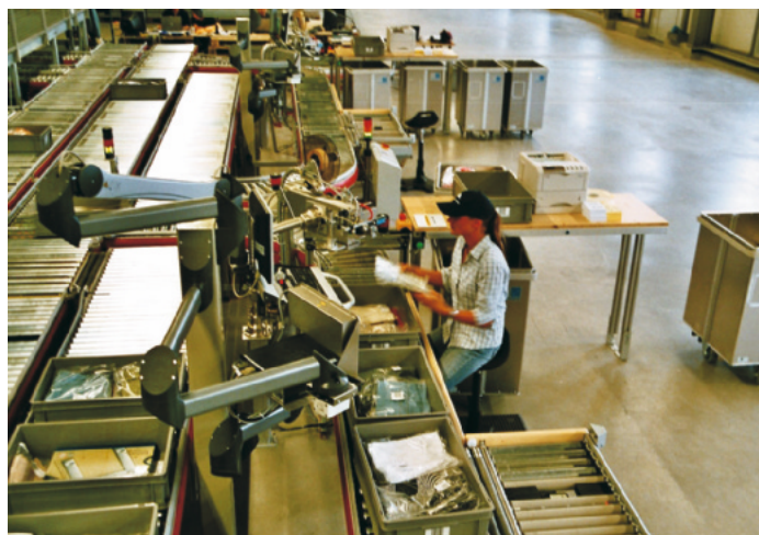
Kommissionierplatz in der Lagervorzone: Die Pickleistung pro Arbeitskraft wurde mit dem SCS drastisch gesteigert
