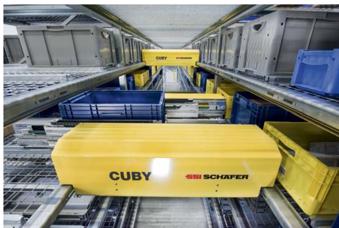
Beim SSI-Schäfer-Shuttle Cuby lagert das optimierte Lastaufnahmemittel Ladungsträger präzise und schnell ein und aus
