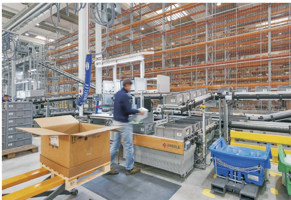
Kommissionierzone in einem von Aberle Logistics realisierten Projekt. Der Pickbereich wird durch eine Fördertechnik mit Behältern aus dem AKL beschickt
