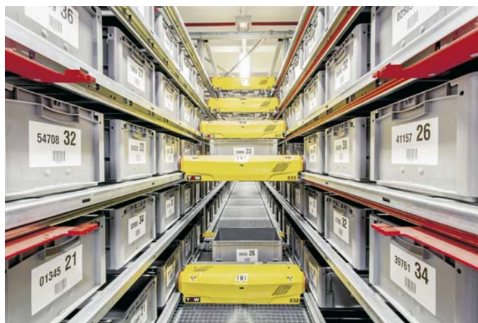
Stingray-Shuttle von TGW mit Twister-Lastaufnahmemitteln für das einfach-, doppelt- und mehrfachtiefe Ein- und Auslagern
