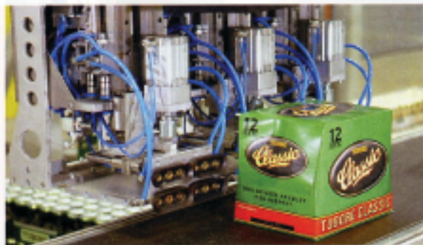
Bild 2: Die Roboter-Greifer können sowohl Kästen, Fässer, Dosen-Trays als auch Kartons zuverlässig erkennen und entsprechend „handeln“
