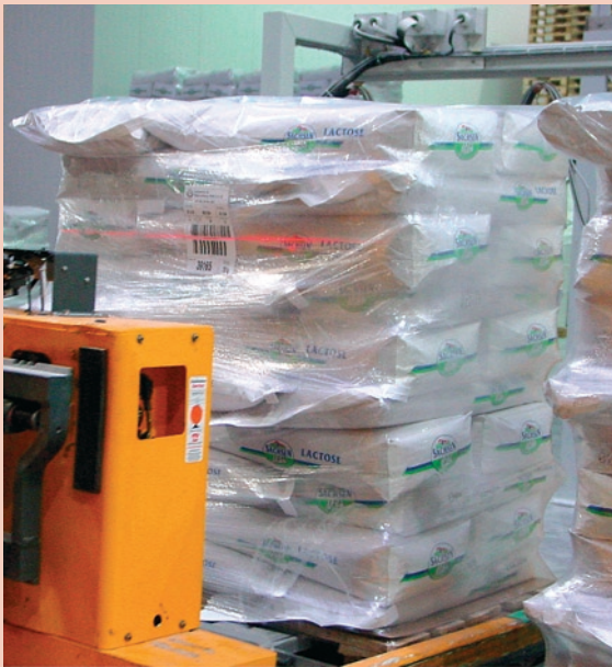
Bild 3: Bei Sachsenmilch werden die Auslagerungsprozesse über RFID gesteuert und zusätzlich per Barcode verifiziert
