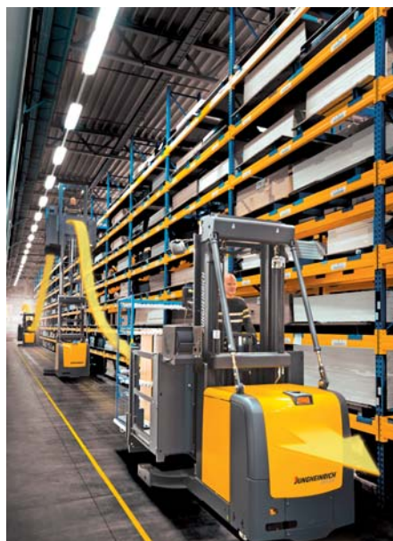
Synchronisierter Material- und Informationsfluss im Schmalganglager: Halbautomatische Anfahrt der Positionen mit einem Vertikalkommissionierer EKS und Lagernavigation
