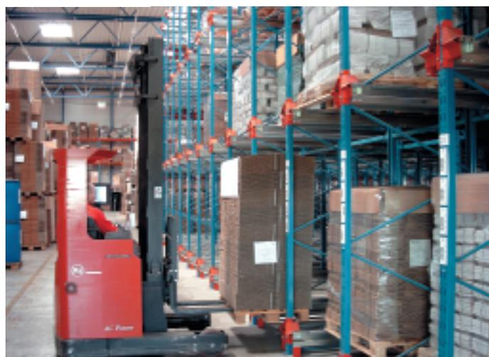
3 Der Zielplatz wird dem Staplerfahrer bei der Einlagerung auf seinem Terminal angezeigt
