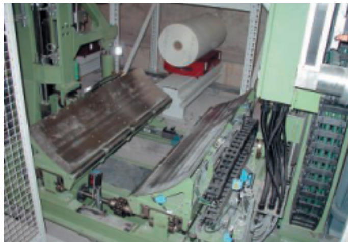
4 Für Restrollen sind spezielle Adapterplätze vorgesehen. Das RFZ kann auch Rollen geringerer Größe problemlos handhaben
