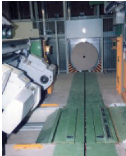
3 Eine Rolle aus dem Tageslager befindet sich auf der Auslagerungsbahn zum Rollenwechsler an der Rotationsmaschine
