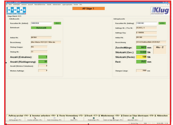
Die Module iWACS.WM und iWACS.MFC steuern Lagerverwaltung und Materialfluss und nutzen somit alle Synergien.
