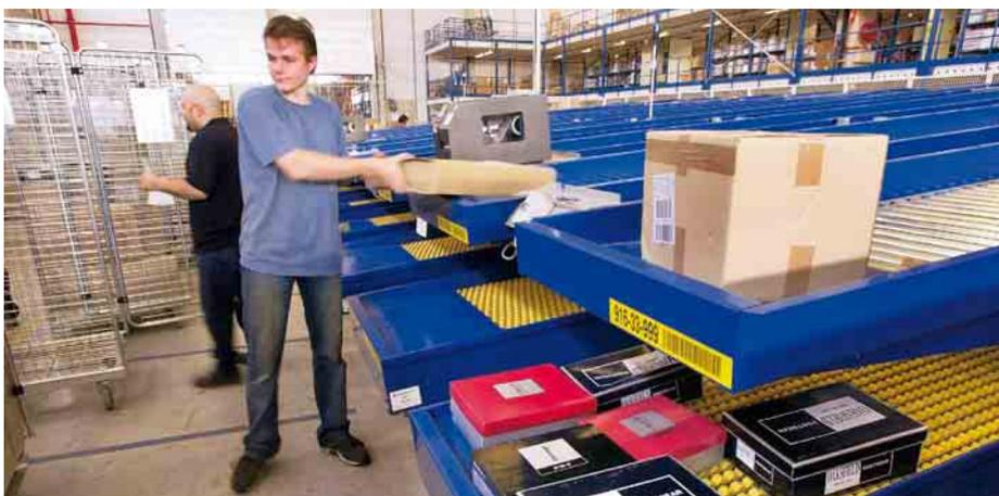
**5 Zwei Ausgangsbahnen pro Sortierausgang – einer für Umkartons und einer für Paar-Kartons**
