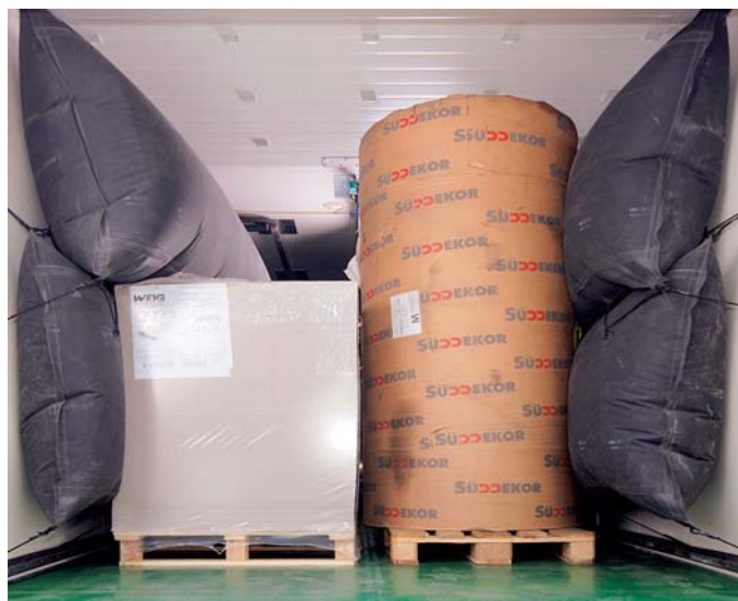
1 Ladungssicherung auf der LKW-Ladefläche mit aufblasbaren Luftkissen
