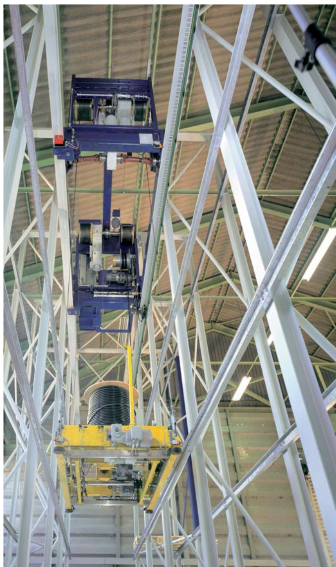
2 Flurfreie und schnelle Regalbedienung mit dem TransFaster®
